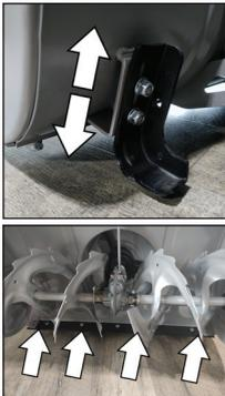
1. Maschine mittels Druckknopf Höhenverstellung (16) nach hinten kippen.
