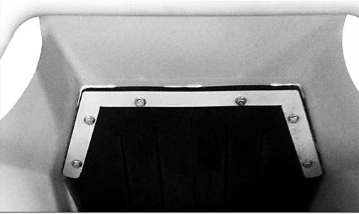
Das Gegenmesser mit Hilfe von einer Dickenlehre auf Schnittspalt von 0,5 mm einstellen. Anschließend die Befestigungsschrauben gleichmäßig festziehen.
