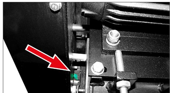
Der 2. Schmiernippel befindet sich hinter dem Keilriemenschutz. Die 4 Befestigungsschrauben an der Riemenverkleidung lösen und Abdeckung abnehmen.
